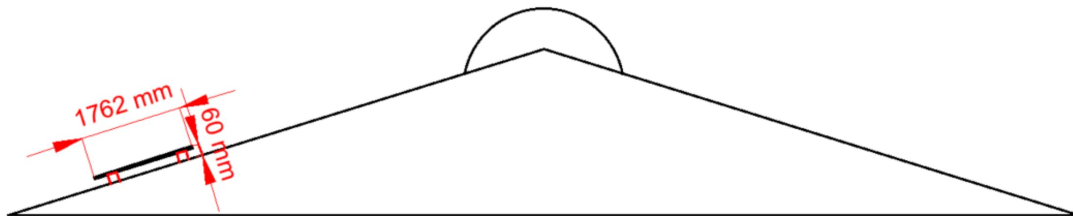
Installation des panneaux en surimposition de 60mm au dessus de la toiture
