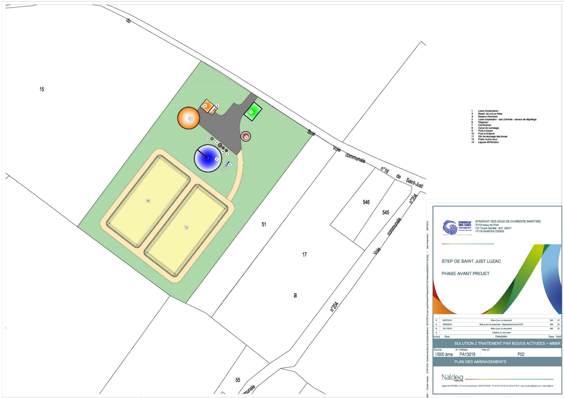
Figure 6 : Plan du projet de STEP (Variante 2)
